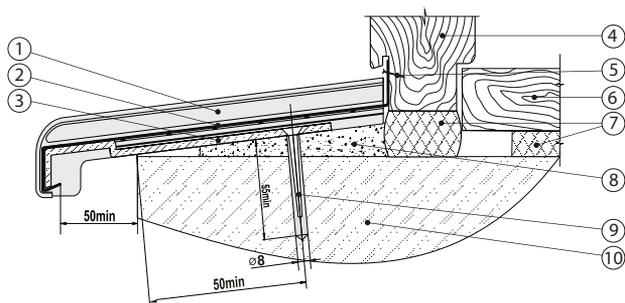
Схема монтажа отлива с кронштейном опорным под цементную стяжку
